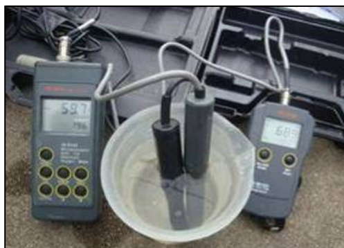
Fotografia 3: Medição do pH, Temperatura, Condutividade e Oxigénio Dissolvido com recurso a sondas portáteis
